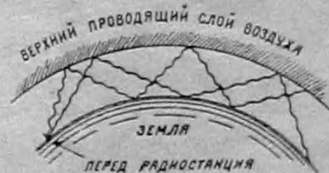
Рис. 3. Отражение эл.-маг. волн от верхнего проводящего слоя.
