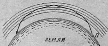
Рис. 6. Преломление электромагнитных волн.
