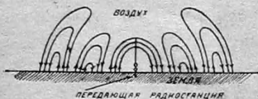
Рис. 1. Теоретическая картина распространения электромагнитных волн.
